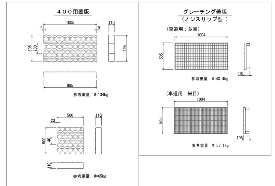
自由勾配側溝（土留用）FSD400 断面図
